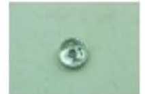
Результат: излом произошел под нагрузкой в 310 кг.
